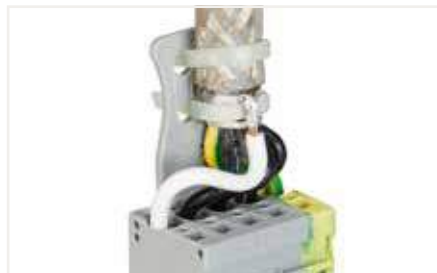
Hem koruma iletkenini hem de koruma sonlandırmasını (790-350) kablo bağlarını kullanarak gerilim azaltma plakasına sabitleyin.
