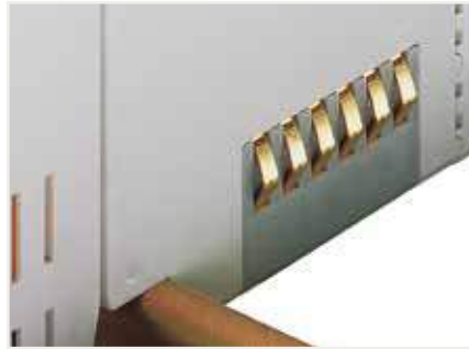
Altın kaplamalı basınç kontaktları aracılığıyla güvenli, otomatik veri ve elektronik güç kaynağı bağlantısı
