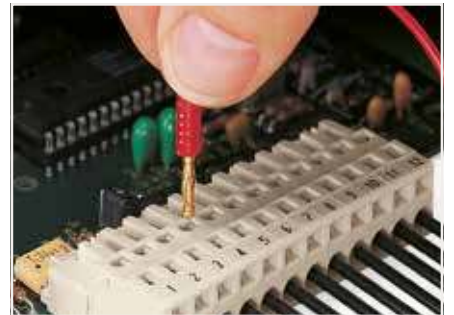
2 mm veya 2,3 mm Ø test fişi ile test.
