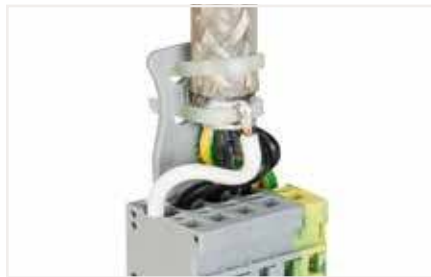
(790-350) kablo bağlarını kullanarak gerilim azaltma plakasına, hem ekran iletkenini hem de ekran sonlandırmasını sabitleyin.
