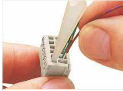
Açma aparatı aracılığıyla bir iletken takma. (Ürün No. 233-332. iletken girişine paralel çalışma
