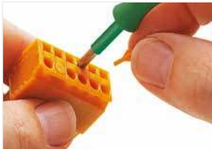
CAGE CLAMP® donanımlı erkek ve dişi konnektörlerde kullanılmayan bağlama birimlerinin kaplanması (örneğin, boşluk ve kaçak mesafesi gereksinimlerini karşılamak için pin aralığını ikiye katlamak veya daha yüksek bir nominal voltaj gerektiğinde) Kilitleme pinleri, panele monte, açılı dişi konnektörler için uygun değildir.
